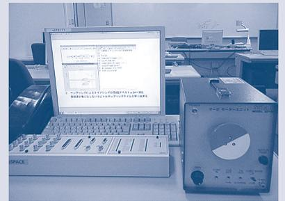
サーボ制御シミュレーション装置
