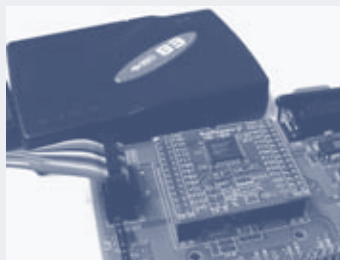
開発用ターゲットボード（H8マイコンとデバッグ）
